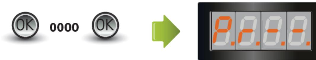
Ingrese el número 10 seguido de la tecla OK verificar que en el display aparece el número 0, si es diferente presione el número 0 y después presionar OK. (Realizar el procedimiento con rapidez para evitar que el sistema regrese al modo PR --, si es así repetir el procedimiento).
