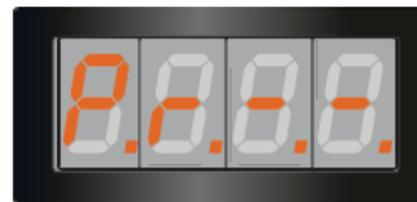
Presionar el numero 20 seguido de la tecla OK. Si en el display observa el numero 0 significara que la función se encuentra desactivada, presione el numero 1 seguido de la tecla OK para activar la función. (Realizar el procedimiento con rapidez para evitar que el sistema regrese al modo PR --, si es así repetir el procedimiento).
